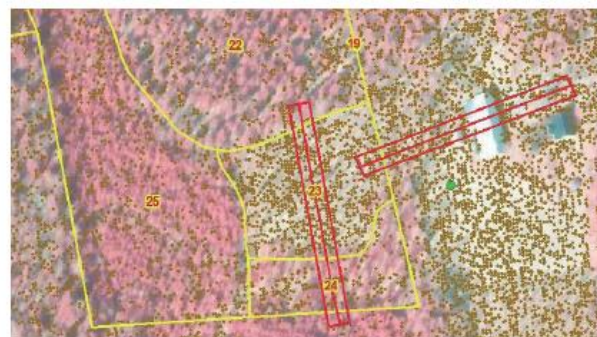
KUVA 13. Vuoden 2013 keilausten maanpintaan osuneet paluupulssit (kuva Pertti Kilpeläinen)
